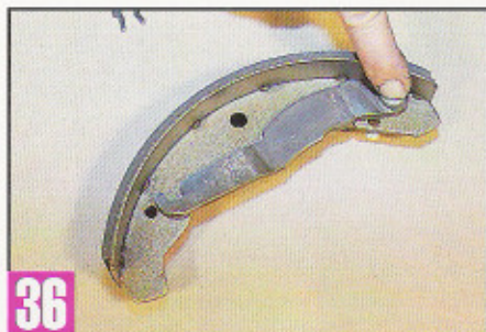
36 Une simple pression du doigt suffit à emmancher l'axe sur la mâchoire. Le crochet du levier est bien sûr dirigé vers l'arrière.
