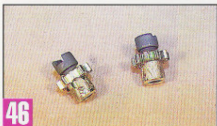
46 Avant de les monter, vissez les portées à fond dans les molettes (mais sans serrer, surtout).
