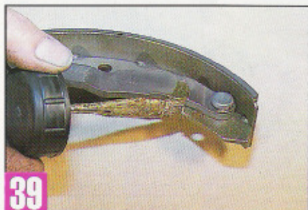
39 Graissez légèrement les endroits où va venir s'emmancher la barre d'accouplement.
