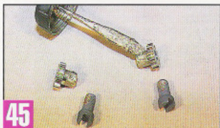
45 Graissez les molettes au niveau de leur emboîtement, toujours avec parcimonie, ainsi que le filetage des portées.
