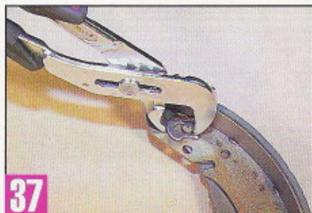
37 Remontez le circlips à l'aide d'une pince...
