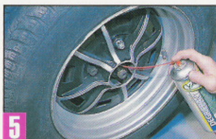
5 En général, il n'est pas nécessaire de démonter la roue. Vous pouvez vous contenter de sortir le tambour avec la roue ! S'il a du mal à venir, mettez un peu de dégrissant entre les cannelures de l'arbre de transmission et le tambour.
