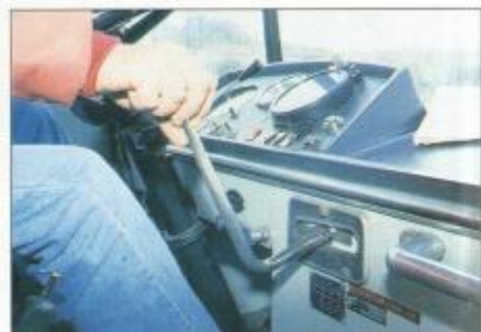
La grille de la boîte ZF à 6 vitesses est inversée : tel un manche de parapluie, le levier de vitesses nous rappelle quelque chose...
