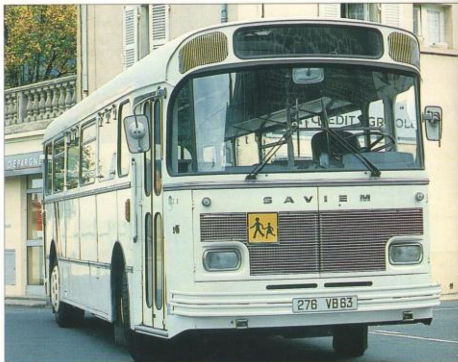
Ce modèle de ligne bénéficie d'un pare-brise surmonté d'une girouette indiquant la destination. Le modèle GT, utilisé plutôt pour les excursions, possède un pare-brise plus haut sans bandeau supérieur.
