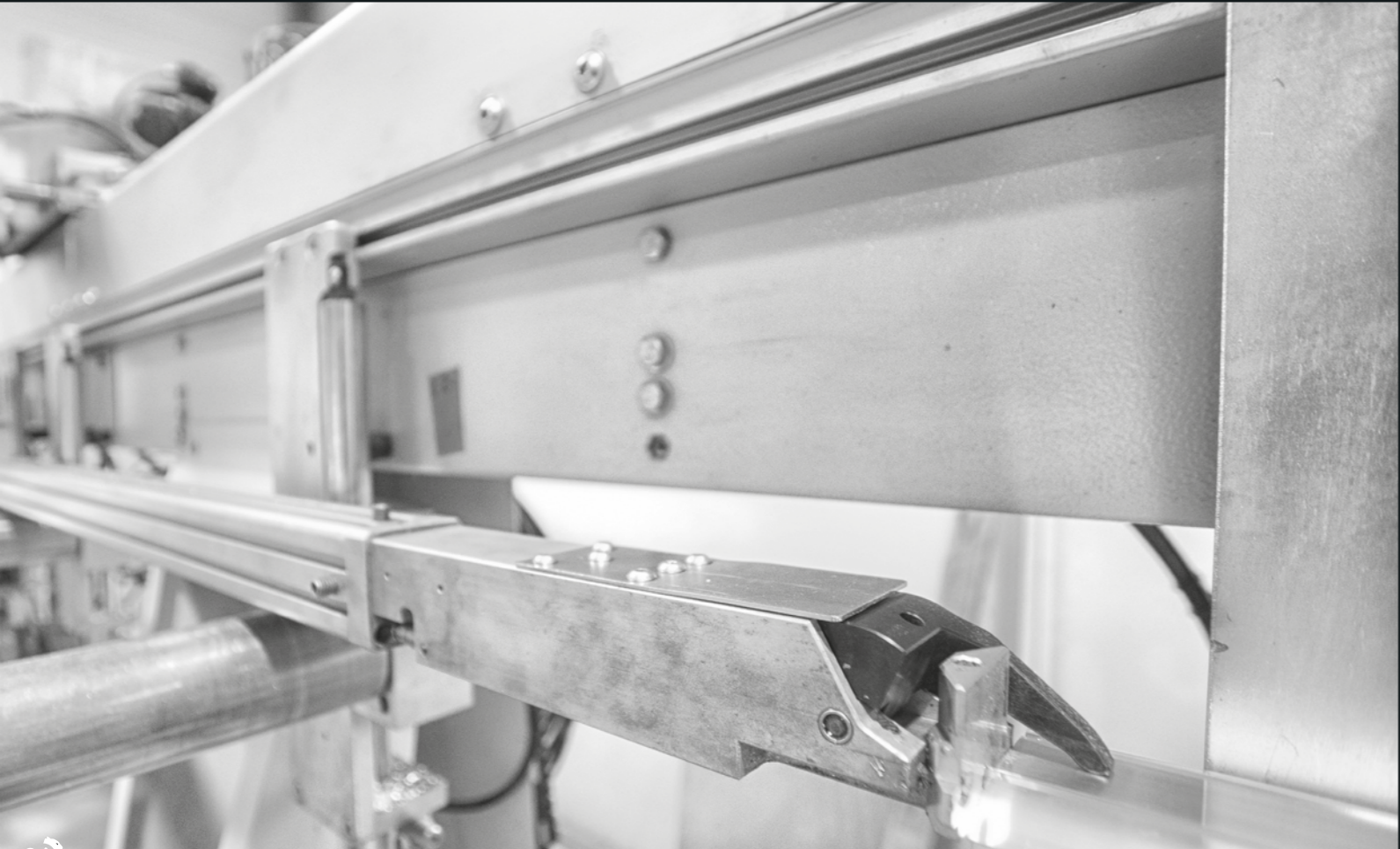
Banc de découpe à débit automatique avec précision au 1/10 ème de mm
