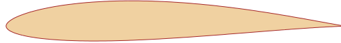
FIGURE 7.6 – Comparaison des profils obtenus à l'aide des transformations de Joukovski et de Kármán-Trefftz à partir d'un cercle générateur décalé de z_c = -0,07 + 0,04i . La valeur de la constante a est réglée pour que l'angle du bord de fuite soit égal à 10^\circ pour le profil de Kármán-Trefftz.
