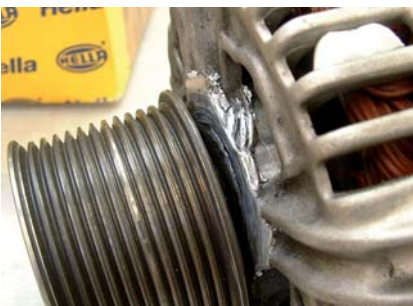
Boîtier d'alternateur endommagé par un palier usé
