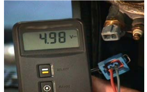
Alimentation au niveau du connecteur du capteur
