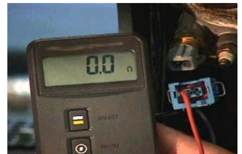
Résistance du faisceau de fils du connecteur du capteur au connecteur du calculateur
