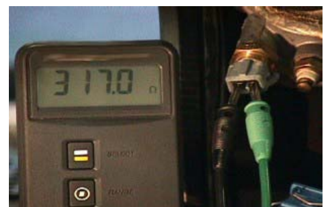
Mesure de la résistance avec moteur chaud
