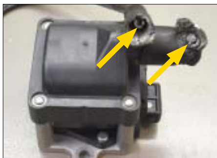
Figure: défaut de contact
