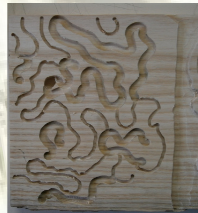
défonçage en suivant un tracé aléatoire à la défonçeuse portable
