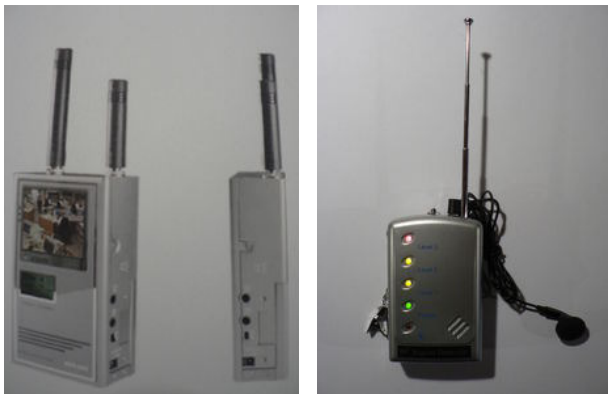
Détecteur de micros espions et caméra HF, GSM 3 à 5 Mhz et Scanner Vidéo de 900 à 2520 Mhz
