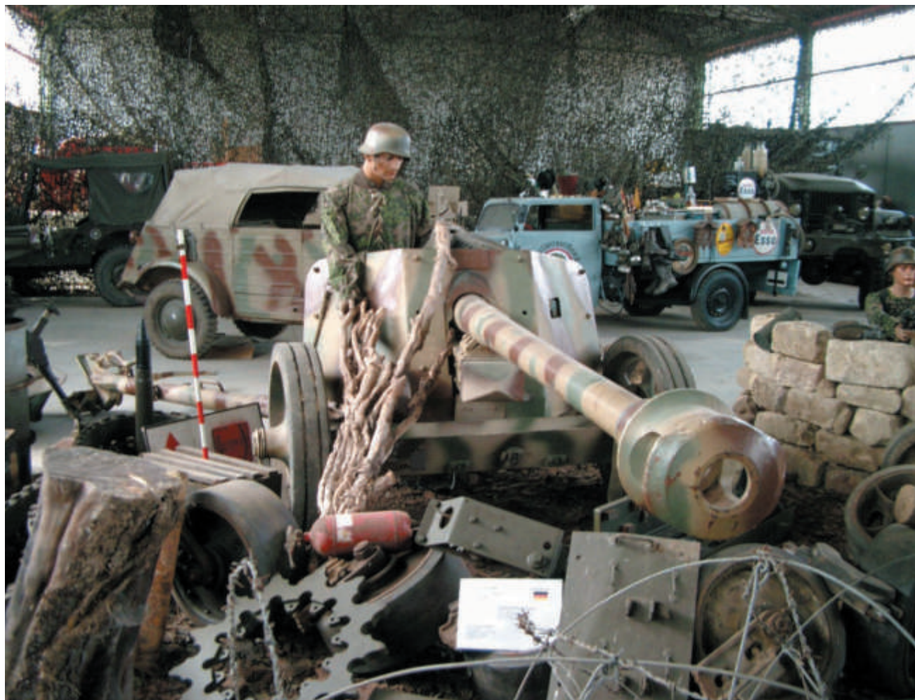
Un canon antichar allemand PAK 40 (Musée de l'Abri, Hatten). Ce canon de 75 mm, version agrandie du PAK 38, a été produit pour faire face à des chars de mieux en mieux protégés. (Photo N. Mengus)
