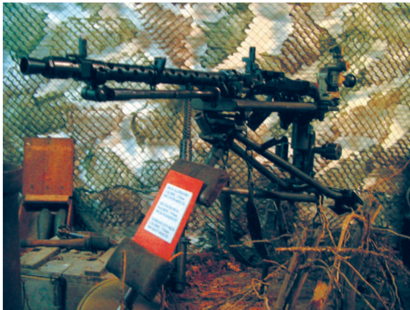
La MG 34, version améliorée de la MG 30, est la mitrailleuse standard de l'Armée allemande. De fabrication difficile et ne supportant guère la boue et la poussière, elle est remplacée, par la suite, par la MG 42 (Musée de l'Abri, Hatten) (Photo N. Mengus)
