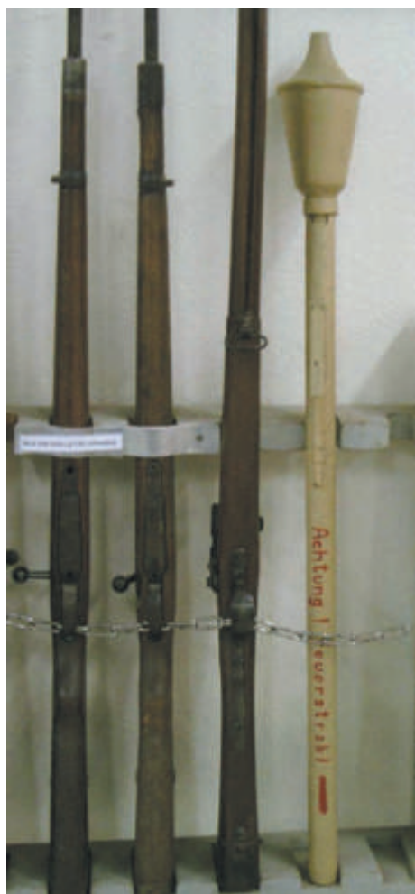
Un Panzerfaust (à droite). Cette arme remarquable, produite en trois tailles différentes à des centaines de milliers d'exemplaires, peut se définir comme un petit canon sans recul tirant une « bombe » dont la charge creuse pouvait percer tous les blindages (Musée de l'ouvrage de la Ligne Maginot du Hochwald - Drachenbronn). (Photo N. Mengus)
